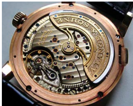
Daymatic搭載L021.1機芯，配置高級砵碼微調擺輪與鵝頸式微調裝置，屬於高級的擒縱結構。
